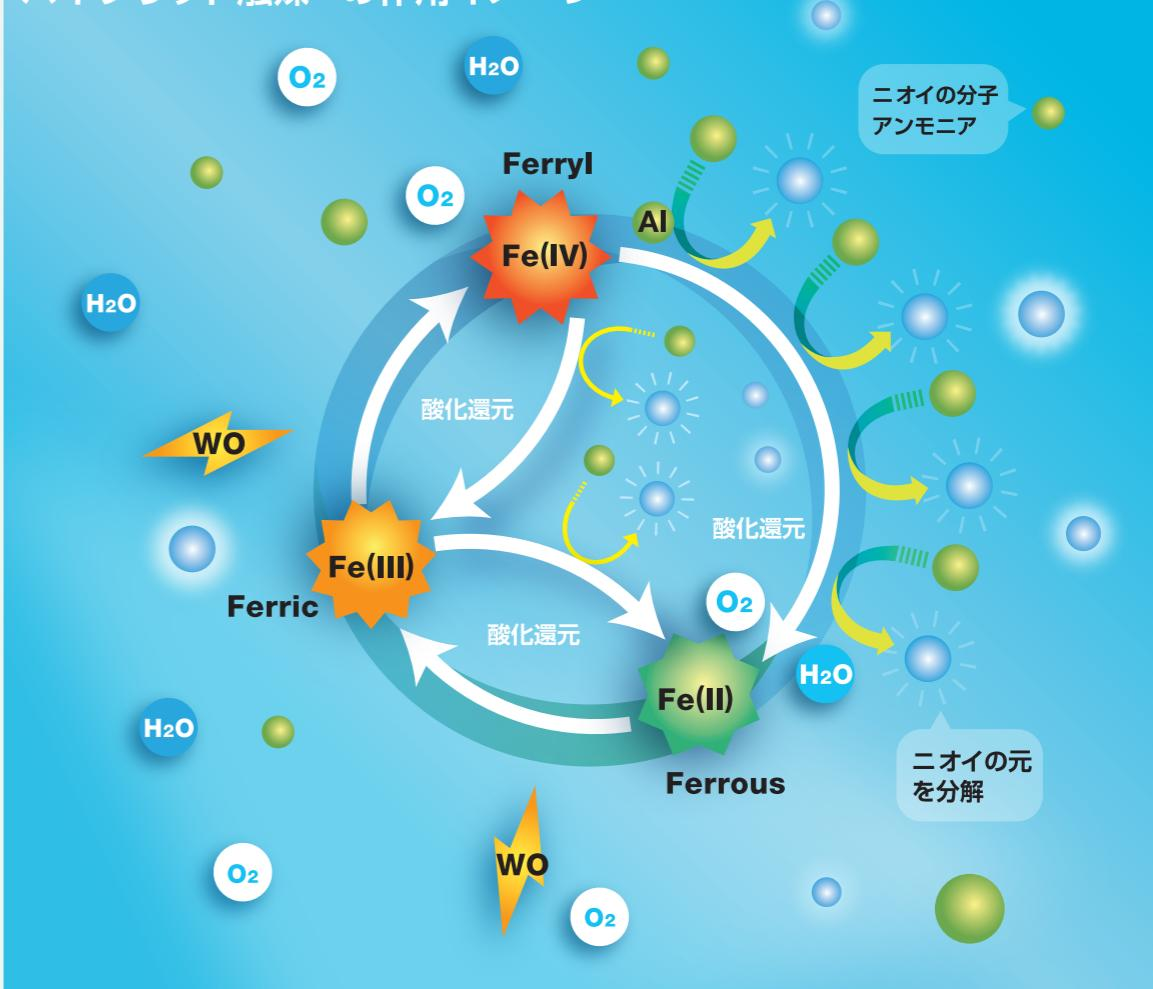
ハイブリッド触媒® TioTio® PREMIUMは、鉄イオン触媒の強力な酸化力を利用して、悪臭物質や細菌類を破壊、分解する新しいタイプの抗菌・消臭機能剤です。
